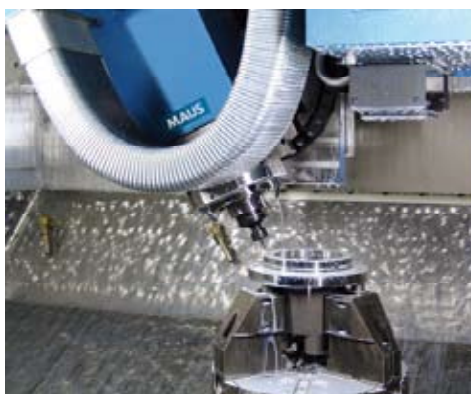
Testa tiltante equipaggiata con utensili modorizzati
