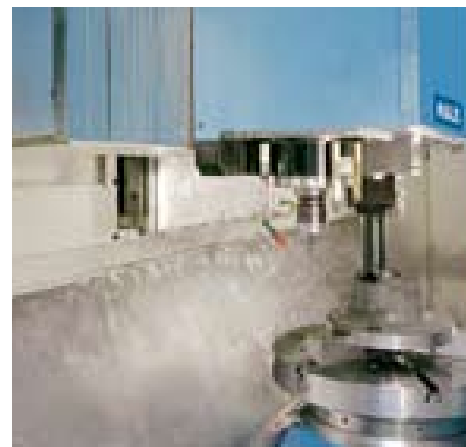
Per la serie MTM le unità di tornitura e foratura sono completamente indipendenti una dall'altra
